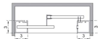
Detalle guía inferior de estanqueidad con dispositivo de liberación de puertas para la limpieza y conservación
